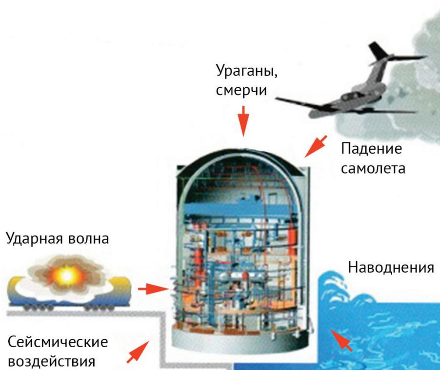
Рис. Контейнер ядерного реактора
