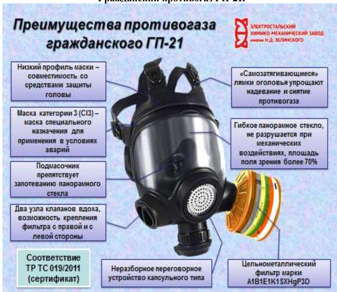
Лицевая часть гражданского противогаза ГП-21 состоит из корпуса в виде низкопрофильной маски объемного типа с подмасочником, obtюратором, отформованным заодно целое с корпусом маски, панорамного «мягкого» стекла термическим способом вмонтированного в корпус, неразборного переговорного устройства капсульного типа, узла выдоха, оголовья, двух узлов вдоха - подсоединения фильтра, один из которых закрыт заглушкой.
