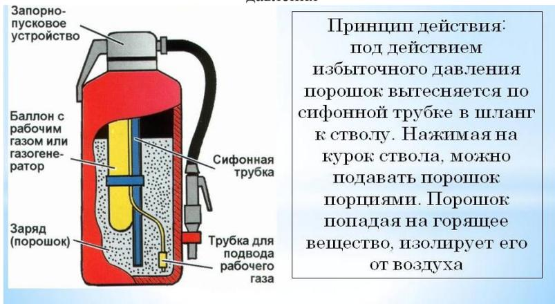
Рис. 29. Порошковые огнетушители с газогенерирующим элементом
