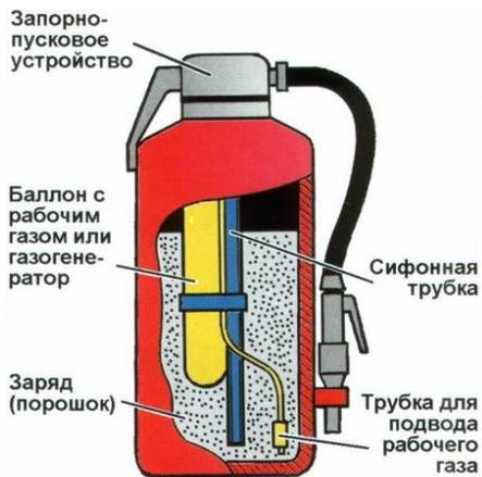
Оснащены устройством для создания (вследствие химической реакции между компонентами наполнителя) избыточного давления в баллоне. Принцип работы таких приборов прост: в результате прокола капсулы происходит смешение наполнителей, вступающих в химическую реакцию и создающих давление в баллоне, которое и вытесняет огнетушащее вещество
