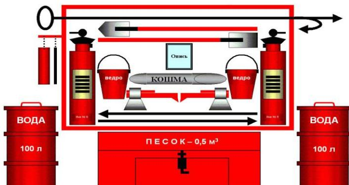
Стандартная комплектация пожарного щита включает лом, лопату, багор, два конусных ведра и два огнетушителя.
