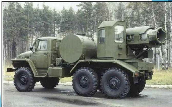
ТМС-65 предназначена для дезактивации техники в полевых условиях.
